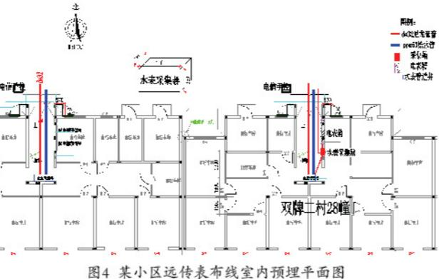
图4 某小区远传表布线室内预埋平面图
