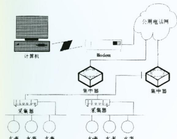
图1 远程水表抄表系统组成示意图
