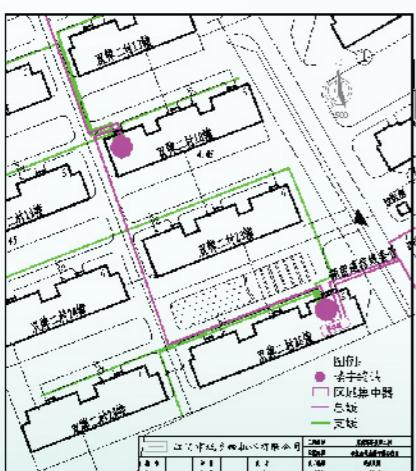
图3 某小区远传表布线平面图
